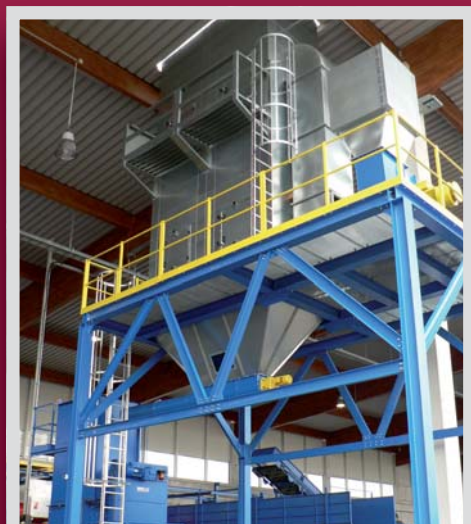
IMPIANTO DI FILTRAGGIO PER L'UNITÀ DI DEPOLVERAZIONE DI UN IMPIANTO DI SELEZIONE
